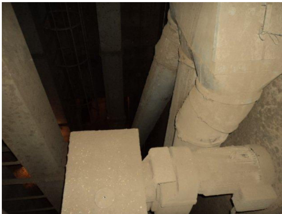
Figura 9: Poeira depositada sobre equipamento no acesso ao túnel subterrâneo da unidade de armazenamento de grãos. Fonte: Brasilagro, 2012.
