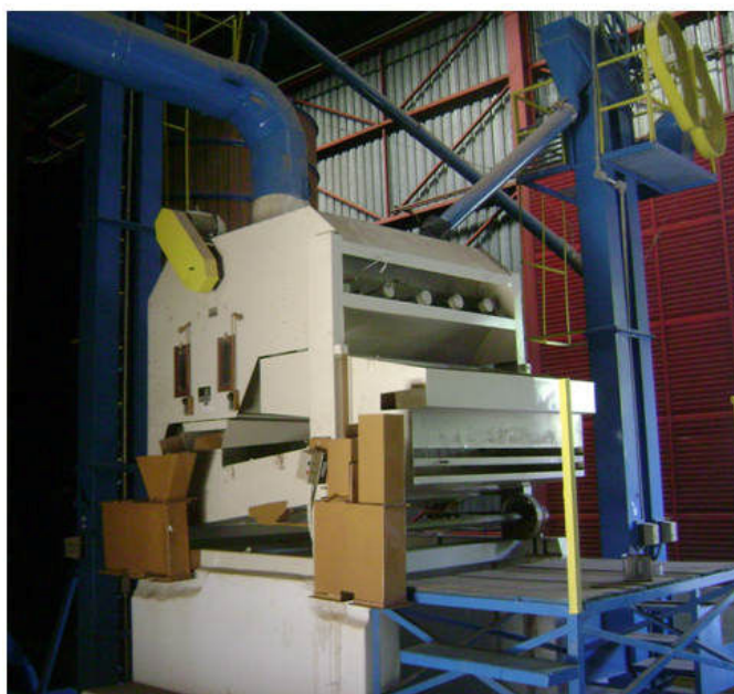
Figura 6: Máquina de ar do sistema ar-peneira, utilizada para limpeza de grãos a granel. Fonte: EMBRAPA Milho e Sorgo, 2007.
